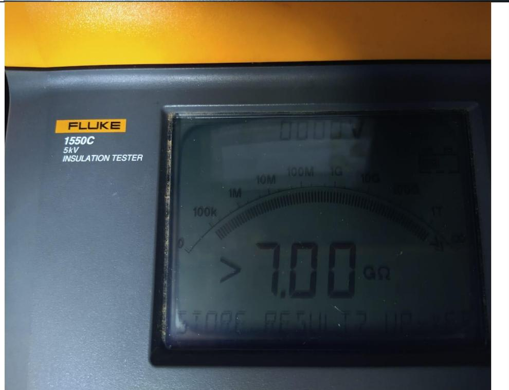
Con las medidas anteriormente mostradas, se puede observar que el aislamiento es el adecuado y puede ser reutilizado, el calibre de la acometida actual es cable #6, y este calibre no es el necesario para las nuevas conexiones, por lo tanto se debe cambiar.
